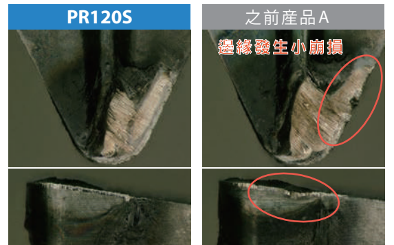
邊緣磨損對比圖 (內部量測結果) 加工50分後
