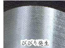
切削條件:  $n = 6,000 \text{ min}$   $V_f = 1,500 \text{ mm/min}$ ,  $a_p \times a_e = 8 \times 2 \text{ mm}$ , 加工徑  $\phi 8$ ,
