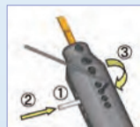
圖1 如何使用調整桿 Fig. 1: How to use adjustment pin
