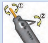
圖2 如何安裝刀片 Fig. 2: How to fix bar
